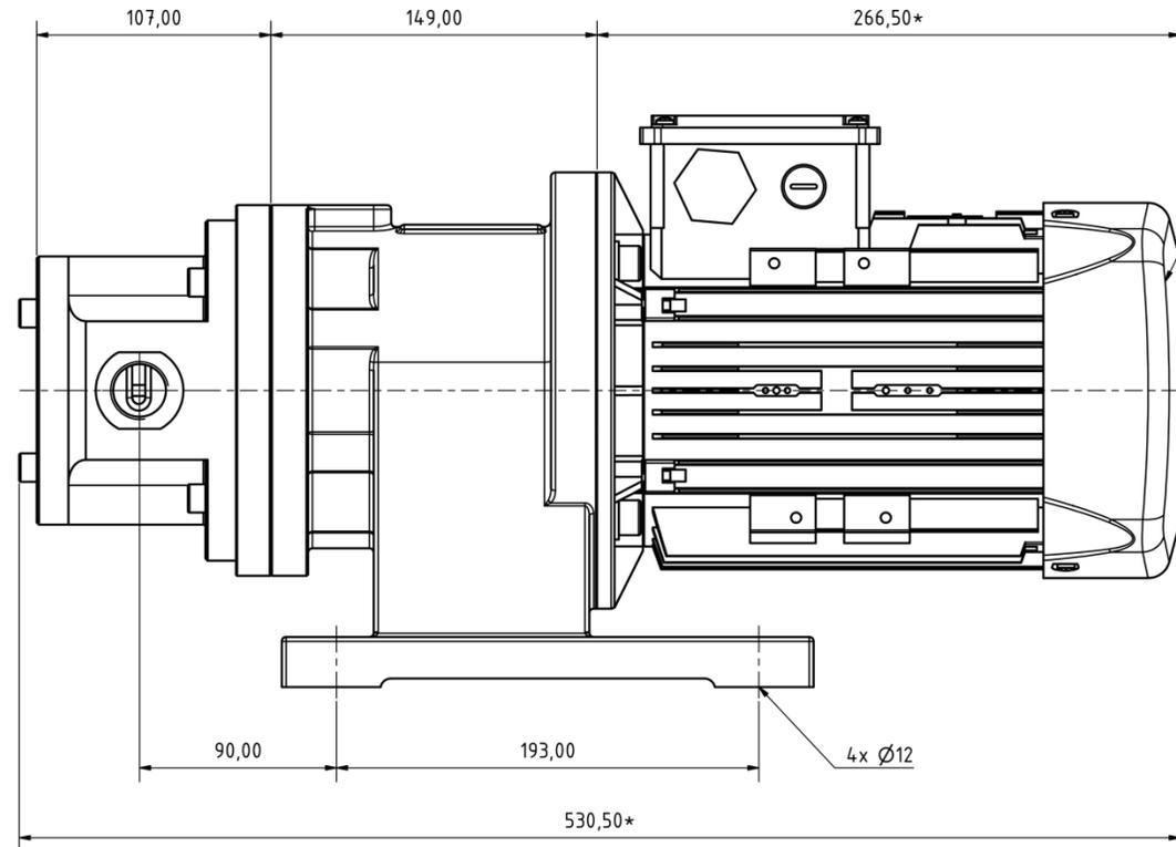
Drehstrom-Asynchronmotor mit Käfigläufer
